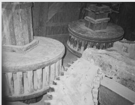
Spoorwiel met rechtsachter de schijfloop voor de pletter, buil, mengketel en vroeger de mosterdsteen; Let op de lichte helling van deze spil.
