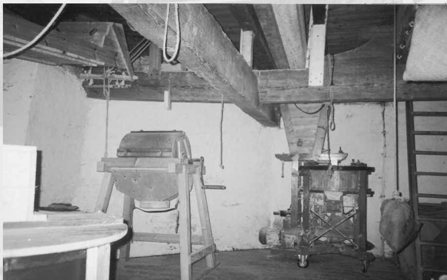
Eerste zolder met van links naar rechts de mengketel, de 'mengton' en het (buiten bedrijf zijnde) maalstoeltje. Het touw met de zak rechts op de foto is de licht: Zo kan men deze (bij buiig weer) ook vanaf deze zolder bedienen!
